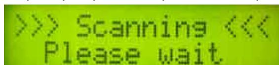
После окончания сканирования на дисплее прибора отобразится частота, на которой КСВ является минимальным, величина КСВ, активное сопротивление и реактивная составляющая.
