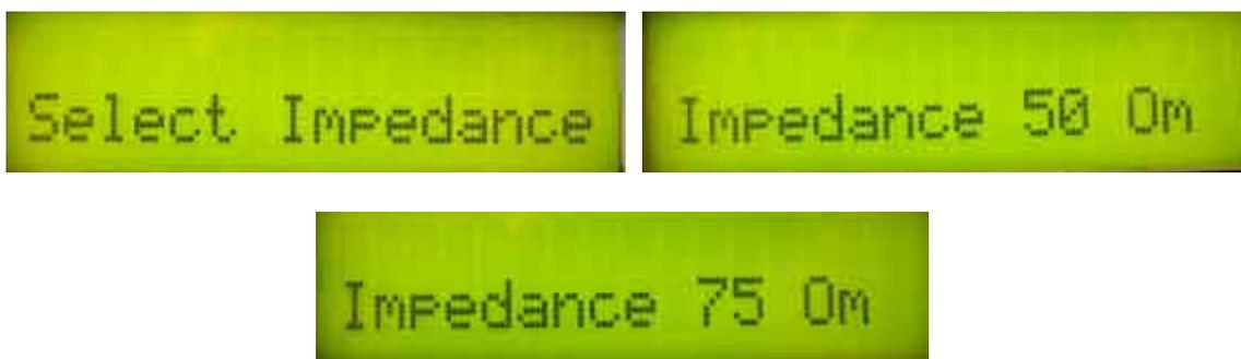
После переключения прибора в режим 75 Ом загорится соответствующий светодиод.
