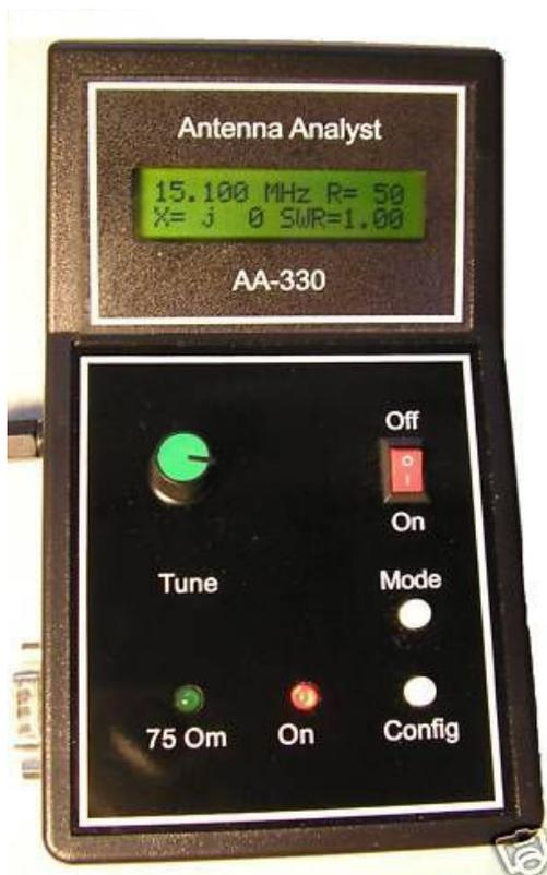
Антенный анализатор AA-330 является продуктом отечественной разработки и предназначен для контроля и исследования основных параметров антенн и фидерных трактов коротковолнового радиочастотного диапазона, лежащего в пределах от 0.5 до 30 мегагерц.
