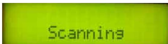
Нажмите на энкодер. Прибор перейдет в режим сканирования
