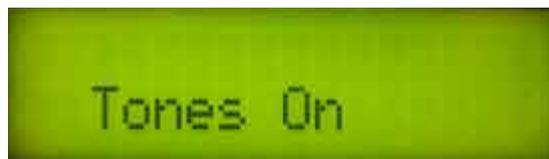
Чем ниже тон, тем меньше КСВ. Удобно при работе непосредственно возле антенны на крыше. Можно не занимая своего внимания на показания прибора, производить настройку согласования антенны по звуковым сигналам антенного анализатора.
