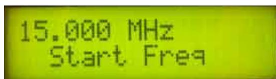
и нажатия на ручку энкодера, прибор сразу же предложит ввести конечную частоту сканирования.
