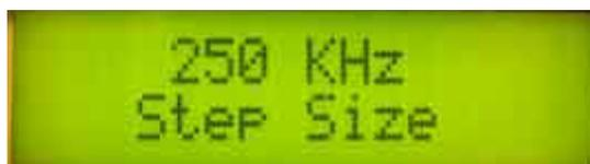
После выбора шага сканирования нажмите на ручку энкодера до появления звукового сигнала.
